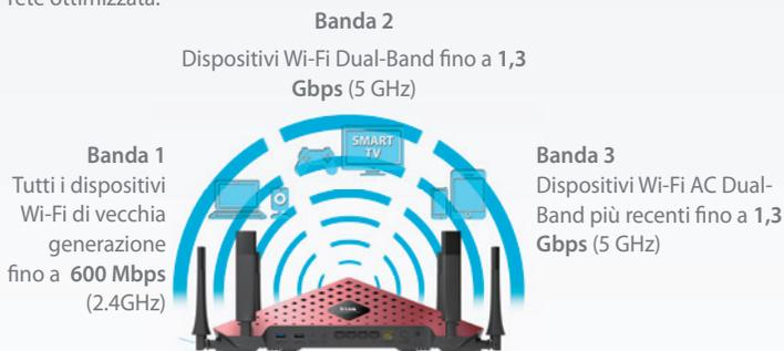
La tecnologia avanzata Quality of Service (QoS) ordina in base alla priorità i dati più importanti, come lo streaming di film e i giochi on-line così da eliminare il buffering di video e minimizzare i tempi di attesa. La funzione SmartConnect bilancia in modo efficace il carico di dati tra le tre bande, mentre la correttezza del tempo di trasmissione garantisce che i client wireless ricevano la larghezza di banda più appropriata per le loro esigenze.
