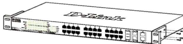
Figure 2. Fixation des supports de montage
