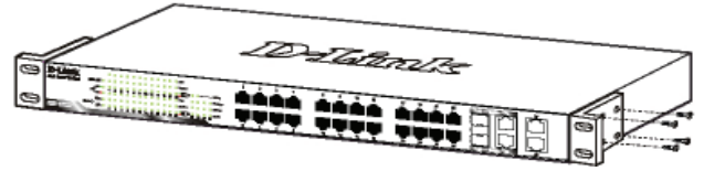
Figura 2. Fixando as braçadeiras de montagem
