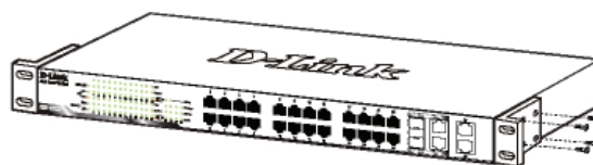
Рисунок 2. Крепление монтажных уголков
