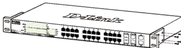
Figura 2. Fissaggio delle staffe di montaggio
